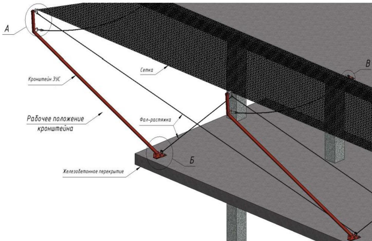
16. Монтаж конструкций следующего участка производится в аналогичной последовательности. По окончании монтажа опускаются следующие 2-4 кронштейна
