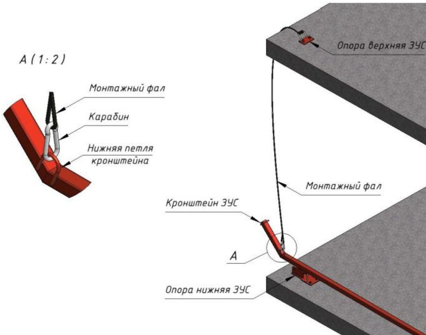
7. Установка и закрепление кронштейнов в исходное положение на опоре нижерасположенного этажа;
